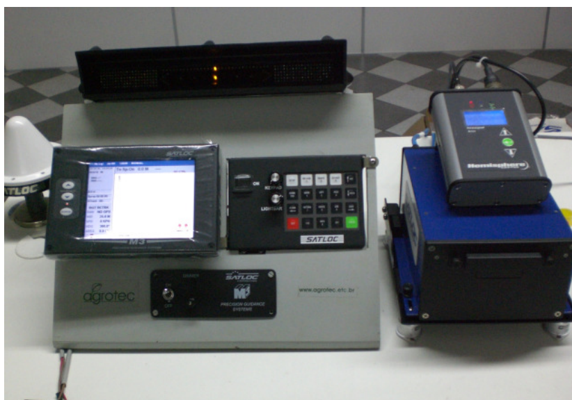
Figura 8 – Sistema DGPS “M3” compatível com o programa AirTrac
